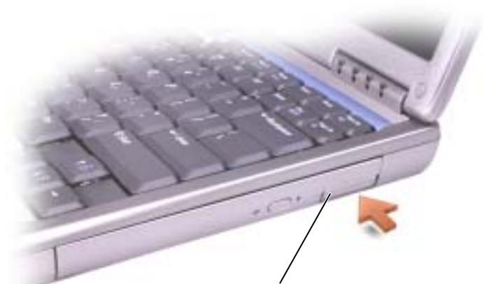
dispositivo di chiusura della periferica
